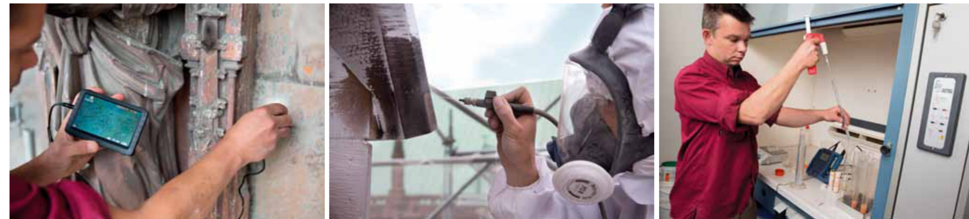
Konservierungsarbeiten: Untersuchung der Polychromie, mikro-abrasive Steinreinigung, Vorbereitungen für die Messung des Salzgehalts.
