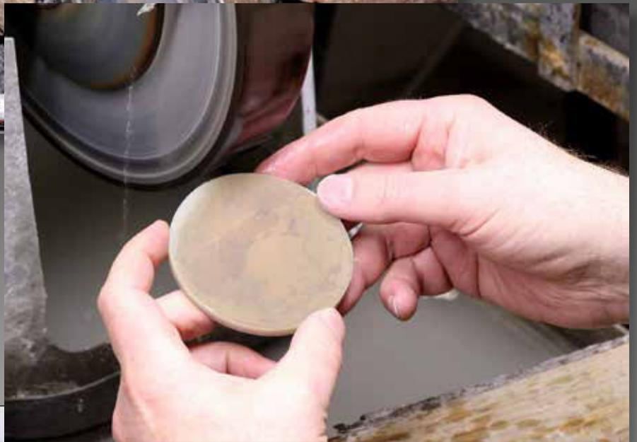
Abb. 12: Der Stein wird in Form geschliffen
